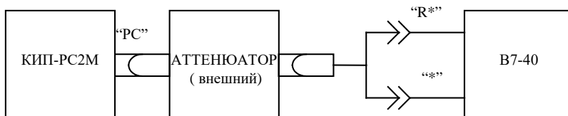
Рисунок 3.27 - Схема проверки сопротивления внешнего аттенюатора.
