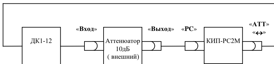
Рисунок 3.14 - Схема измерения ослабления внешнего аттенуатора.
